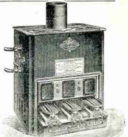
CHAUFFE-BAINS instantané à pétrole « Flamme bleue », à circulation d'eau continue. Faisceau tubulaire cuivre rouge. Lampe à trois becs, double mèches plates de 0 m 20. Consommation moyenne : 3/4 de litre de pétrole pour un bain.
